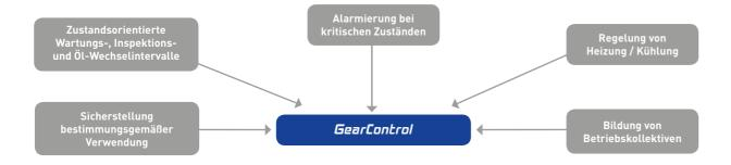
GearControl erfasst den Zustand des Getriebes über die gesamte Produktlebensdauer von der Erprobungsphase beim Hersteller sowie während der gesamten Betriebs- und Stillstandszeit. Die daraus gewonnenen Messdaten und abgeleiteten Informationen in Kombination mit den
